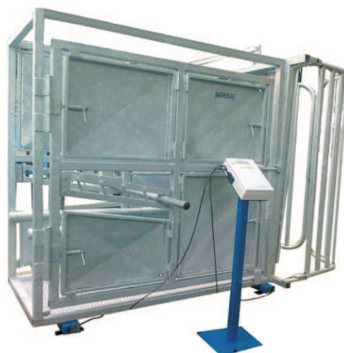
Použití ližin pro vážení fixační klece na dobytek
